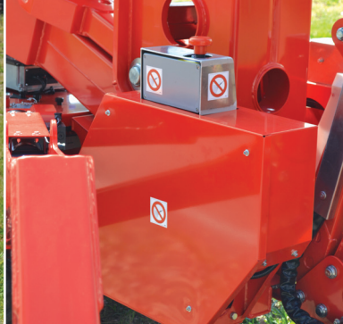
48-V-BATTERIESATZ FÜR DEN HYBRIDBETRIEB
